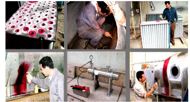
بازرسی جوش با استفاده از مایع نافذ PT
