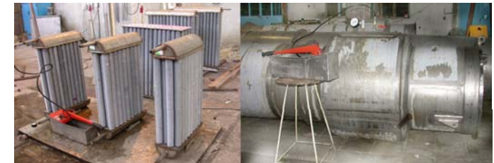
تست فشار (هیدرواستاتیک) مخازن و مبدل های حرارتی
