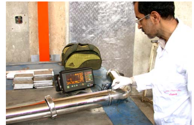
بازرسی غیرمخرب قطعات و اتصالات جوشکاری شده توسط روش UT
