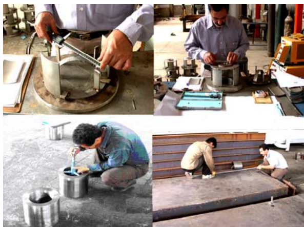
کنترل ابعادی قطعات در حین عملیات مختلف ساخت
